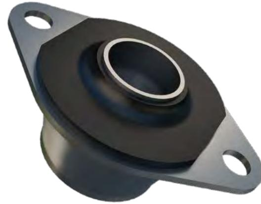
Ihr kompaktes, ausfallsicheres Design ist für eine Vielzahl von Belastungen verfügbar, in einigen Fällen mit alternativen Befestigungen. Ausschnitte in Gummiprofilen in verschiedenen Größen sorgen für ein unterschiedliches Verhältnis zwischen vertikaler und horizontaler Steifigkeit
