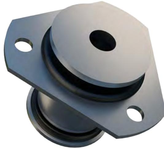
Ihr kompaktes, ausfallsicheres Design ist für eine Vielzahl von Belastungen verfügbar, in einigen Fällen mit alternativen Befestigungen. Ausschnitte in Gummiprofilen in verschiedenen Größen sorgen für ein unterschiedliches Verhältnis zwischen vertikaler und horizontaler Steifigkeit
