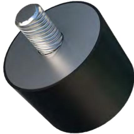
Bobbin mounts können in einer Vielzahl von Anwendungen eingesetzt werden, um eine relative Bewegung der aufgehängten Masse zu ermöglichen und die Auswirkungen von Lärm, Vibrationen und Stößen zu isolieren. Die Spulenträger sind so konzipiert, dass sie eine höhere Steifigkeit auf Druck und eine geringere Steifigkeit auf Scherung aufweisen.
